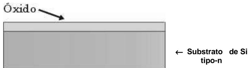
Figura 4- Representação da lâmina de Si em corte lateral com óxido de campo crescido.
