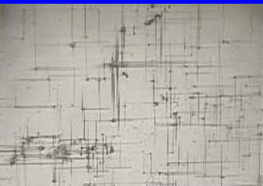
Stacking faults: a) 2 min. etch (55x) e b) 25 min etch (280x)
