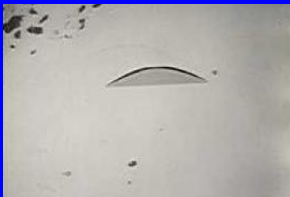
Stacking faults: a) 2 min. etch (55x) e b) 25 min etch (280x)
